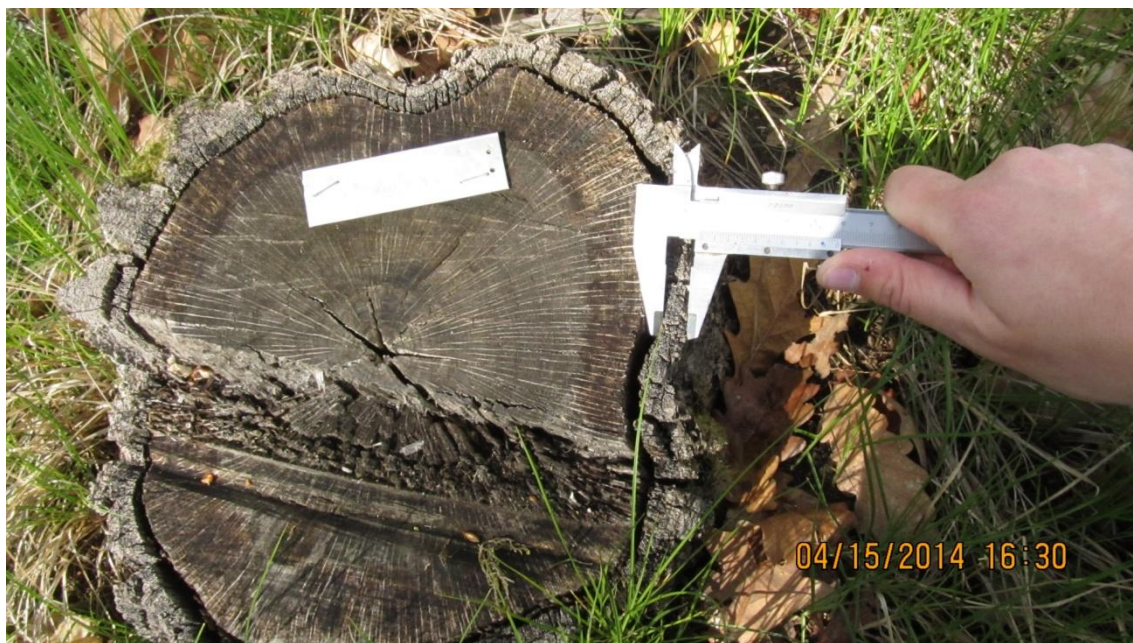
Obr. 19: Měření tloušťky kůry
