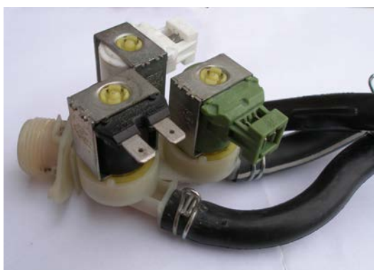
Obrázek 14: Trojitý Elmag. ventil z pračky
