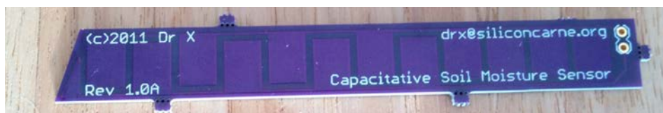
Obrázek 11: Kapacitní senzor podle DrX
