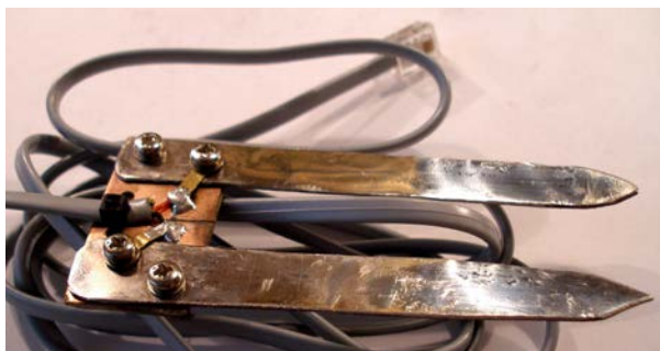
Obrázek 10: Senzor vlastní konstrukce bez izolace
