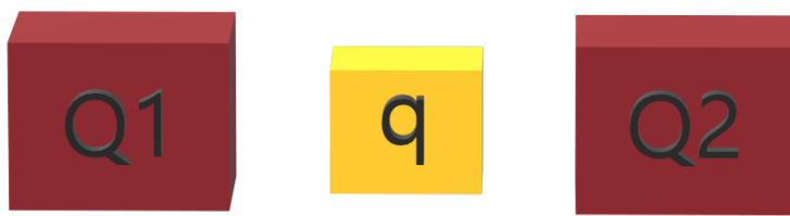
Obrázek 7 Schéma tandemového uspořádání hmotnostního spektrometru typu – trojitý kvadrupól
