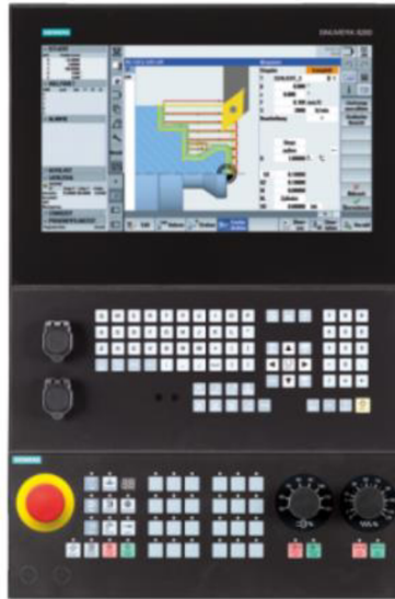
Obr. 11 Ukázka panelu pro řídicí systém SINUMERIK 828D [13]
