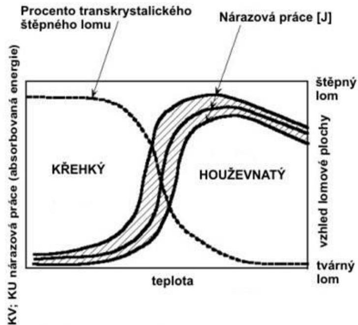
Obrázek č. 3: Podíl křehkého a houževnatého lomu. Převzato z [14].
