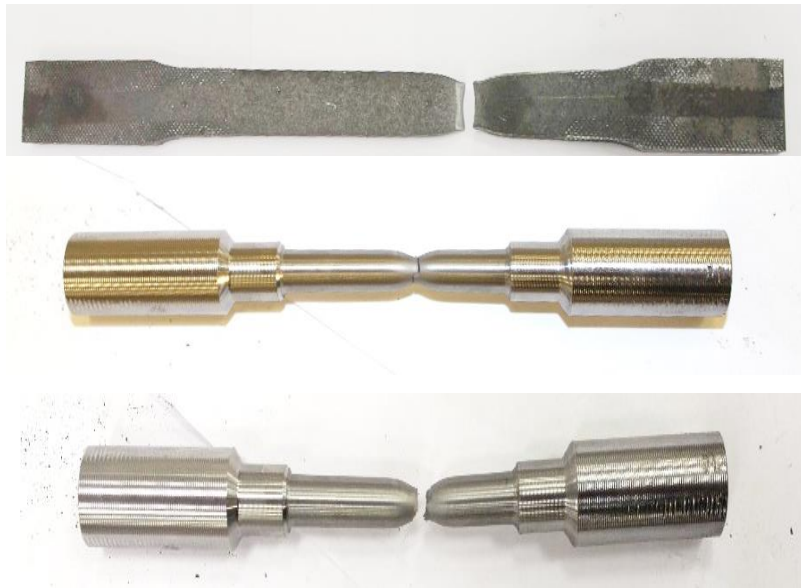
Obrázek č. 17: a) Vzorky pro zkoušku tahem před zkouškou – náhodný výběr, b) po zkoušce – náhodný výběr.
