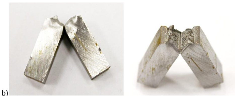
Obrázek č. 15: Vzorky pro zkoušku rázem v ohybu, a) před zkouškou, b) po zkoušce.
