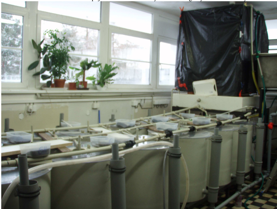
Příloha č. 17: Odchovné nádrže napojené na recirkulační systém s biologickým čištěním vody
