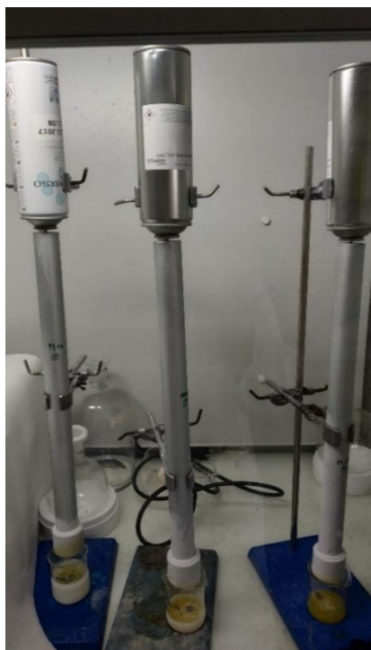
Obr. 4 Extrakce dimethyl etherem
