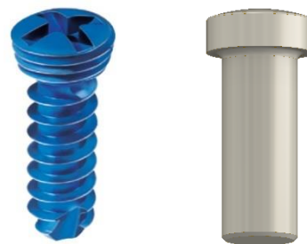
Obrázek 9.3: „Locking“ šroub (vlevo) a zjednodušený model (vpravo)
