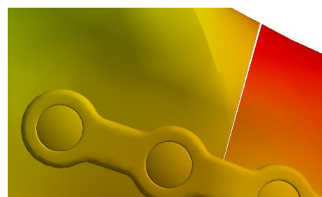
Obrázek 10.6: Skutečná velikost posuvu lomových ploch
