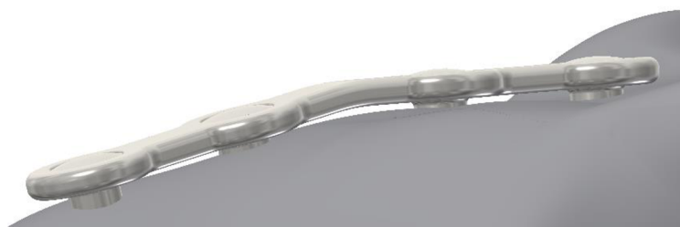
Obrázek 9.1: Vytvořeno v programu Autodesk Inventor (mezera v rozsahu 0,2 - 0,5 mm)
