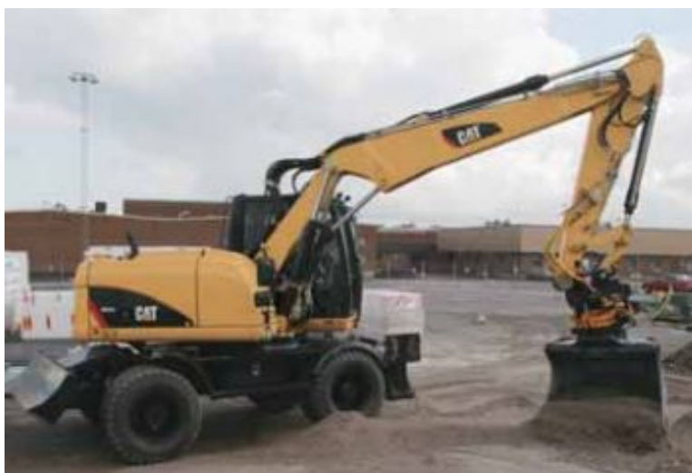
Obr. 5.5b Kolové rypadlo Caterpillar M315D
