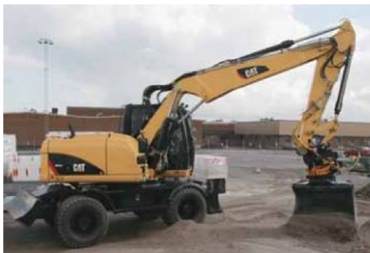
Obr. 5.5b Kolové rypadlo Caterpillar M315D
