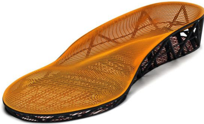
Obr. 4 Vytištěný model v 3D tisku (Kloski 2021)
