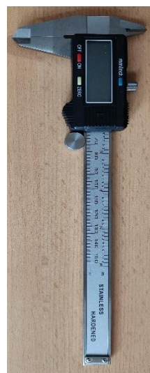
Obr. 23 Posuvné měřítko (vlastní tvorba)
