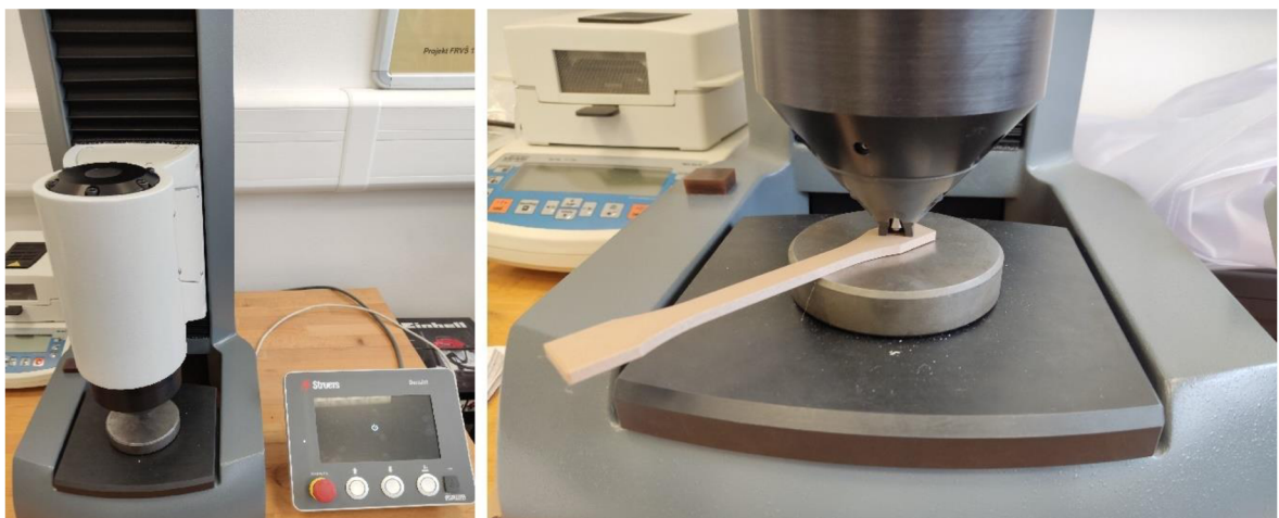
Obr. 26 Tvrdoměr DuraJet G5 a průběh zkoušek tvrdosti (vlastní tvorba)
