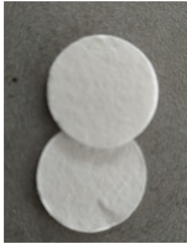
Obr. 4-9 Použitý separátor průměru 18 mm.
