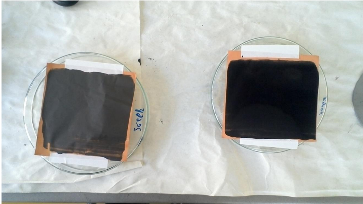
Obr. 4-3 Elektrody připravené na vysekávání. Nalevo uhlík, napravo \text{Na}_2\text{Ti}_3\text{O}_7 .
