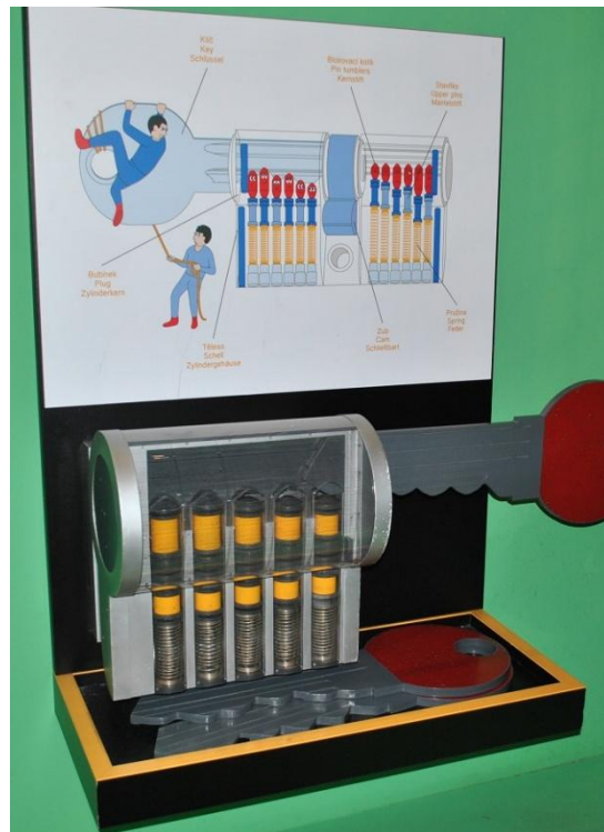
Obrázek 23 - Princip zámku a klíče
