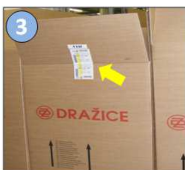
3. Na obal nalepit cenovku (cenovky dle typu ohřívače). Pracovní pomůcky: štětec, lepidlo DEXTRIN
