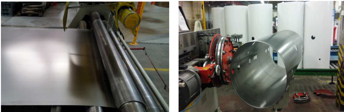
Obrázek 5: Stáčení (vlevo) a pertlování (vpravo) pláště [zdroj: vlastní]
