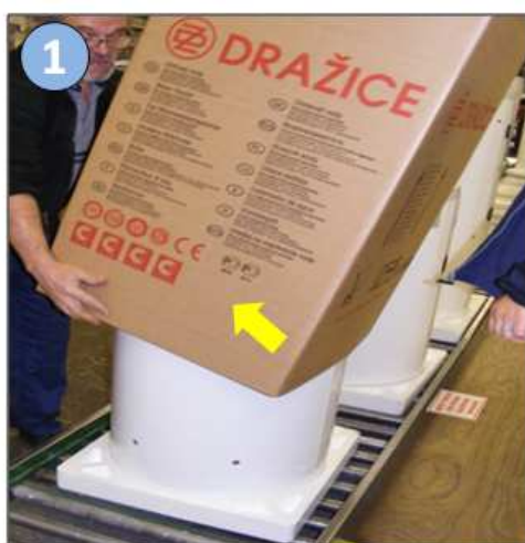
1. Na ohřívač nasadit příslušný kartonový obal (kartonový obal dle typu ohřívače).
