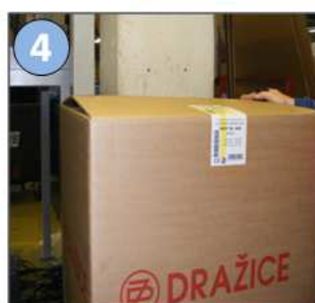
4. Zkontrolovat úplnost balení a kontrolu potvrdit razítkem umístěným na kartonový obal vedle cenovky. Složit chlopně obalu a převézt ohřívač k páskovacímu stroji Sander.
