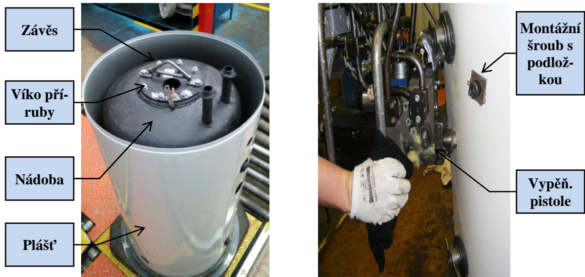
Obrázek 7: Nasazení pláště na nádobu (vlevo) a vypěnění (vpravo) [zdroj: vlastní]
