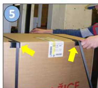
5. Na obal přiložit 4ks PP rohů a 2x přepáskovat obal stisknutím pedálu. Bezpečnost práce: dodržet bezpečnost práce dle ČSN EN 415-2 Vstupní mat.: Roh ochranný PP - č.d.6321827
