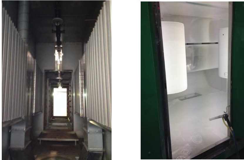
Obrázek 6: Odmašťovací (vlevo) a lakovací (vpravo) operace [zdroj: vlastní]
