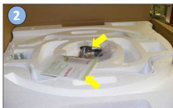
2. Do krabice vložit horní polystyrenový prolis. Tvarovku položit na ohřívač tak, aby odlehčení na vnitřní straně tvarovky sedělo na dvířkách panelu. Do prolisů v horní polystyrenové tvarovce vložit teploměr, poj. ventil, CD s návodem a záručním listem + ostatní náležitosti dle zakázky.
