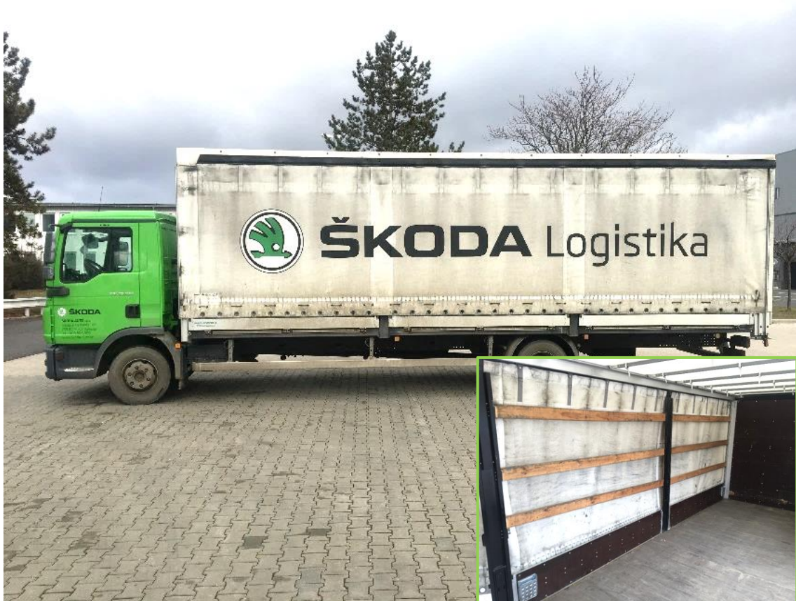
Obrázek 3.1 Klasický způsob uzavření přívěsu
