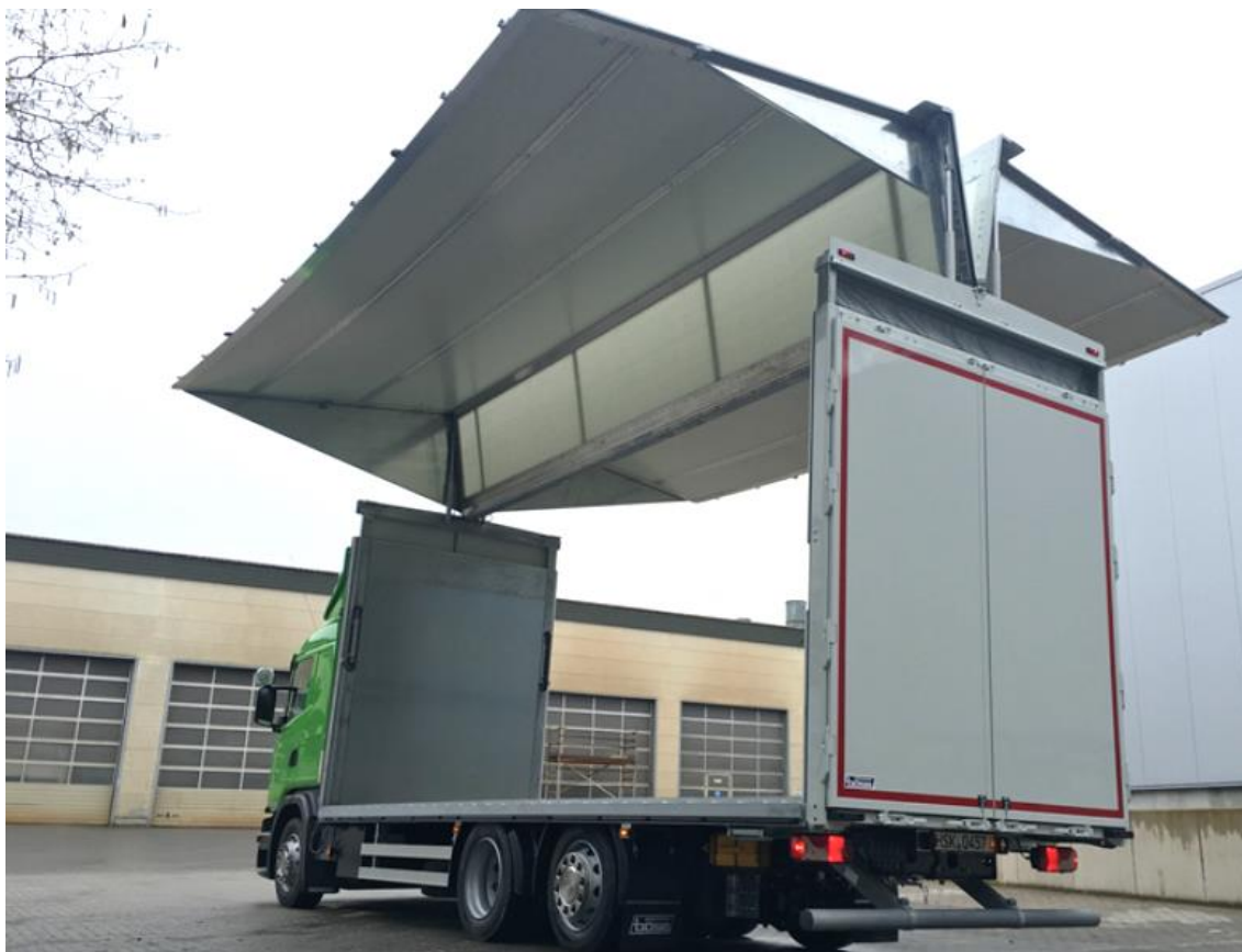
Obrázek 3.4 Nový typ krovky
