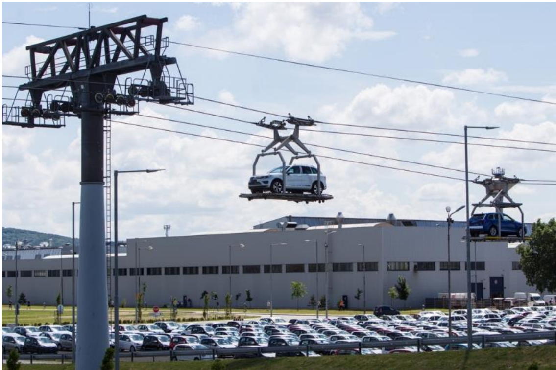
Obrázek 1.10 Lanová dráha pro přepravu automobilů ve VW Bratislava
