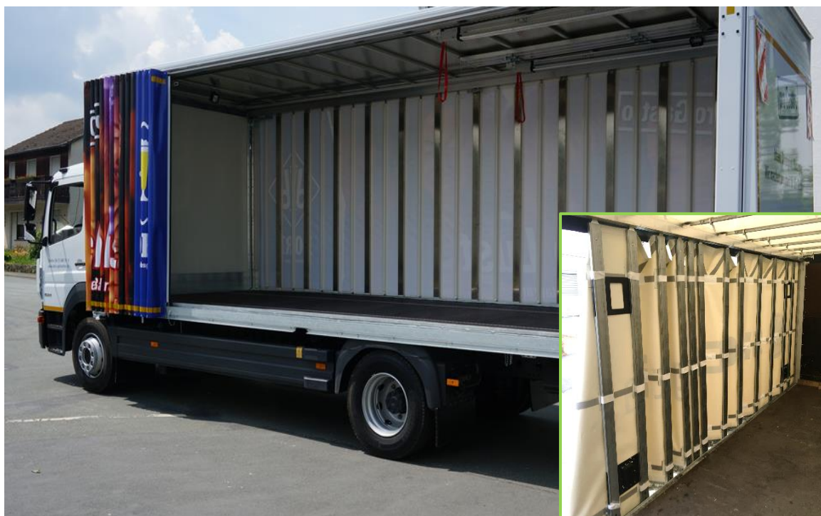
Obrázek 3.2 Lamelový systém bočního shrnování
