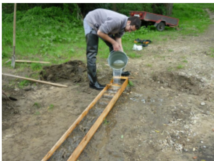
Příloha II – obr. 37: Prolévání materiálu na splavu. Kalná voda odnáší lehký jalový materiál (foto: autor).
