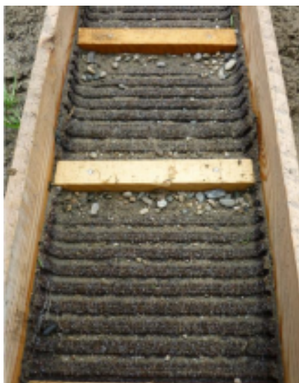
Příloha II – obr. 34: Detail těžkých sedimentů zachycených za příčkami plavu (foto: autor).
