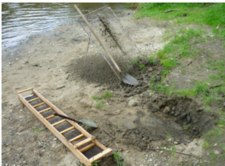
Příloha II – obr. 30: Úprava materiálu před plavením pomocí zednické prohazovačky (foto: autor).
