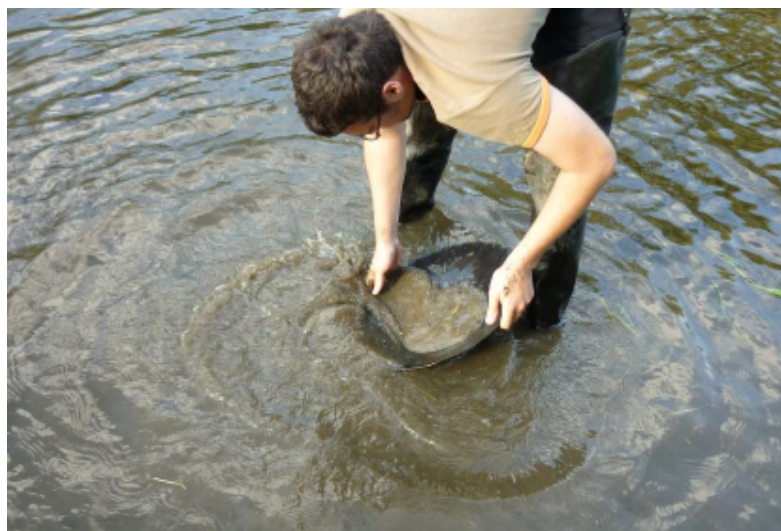
Příloha II – obr. 20: Třetí fáze rýžování. Odplavování jalového materiálu a postupný vznik zlatonosného koncentrátu (foto: autor).
