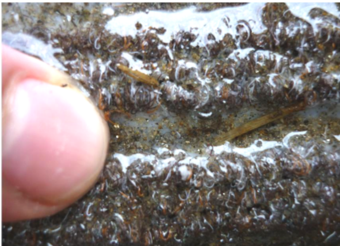
Příloha II – obr. 39: Zlatinka zachycená na zátěžovém koberci dně rýžovníckého splavu, který byl namazán sádlem (foto: autor).
