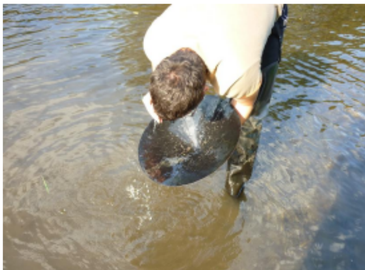
Příloha II – obr. 23: Oddělování jednotlivých zlatinek od sebe opatrným proléváním vodou z dlaně (foto: autor).
