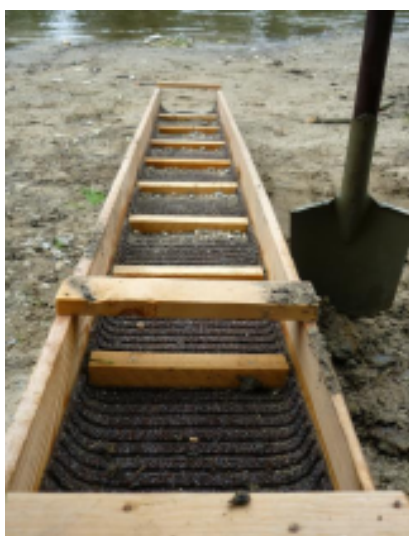
Příloha II – obr. 31: Detail úpravy dna rýžovníckého splavu (foto: autor).
