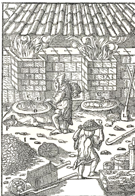
Příloha III – obr. 27: Šachtová pec pro tavbu zlata (Agricola, 1556).
