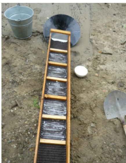
Příloha II – obr. 35: Úprava dna splavu namazáním sádlem. Simulace zachycování zlatinek na ovčí vlně (foto: autor).
