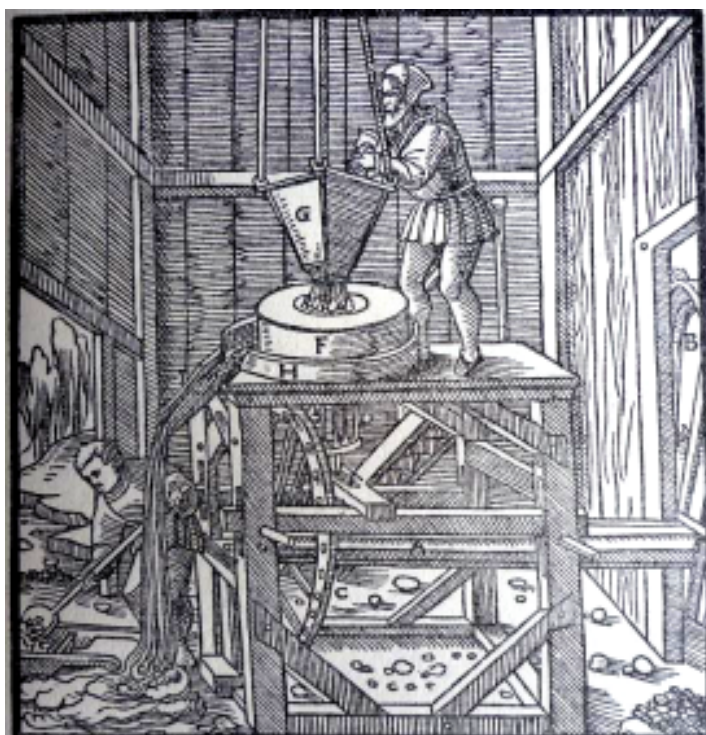
Hřídcl vodního kola A. Vodní kolo B. Palcovní kolo C. Vřetenový převod D. Jeho železná osa E. Svrchní mlýnský kámen F. Násyp G. Kruhový dřevěný žlábek H. Vynáška I.
