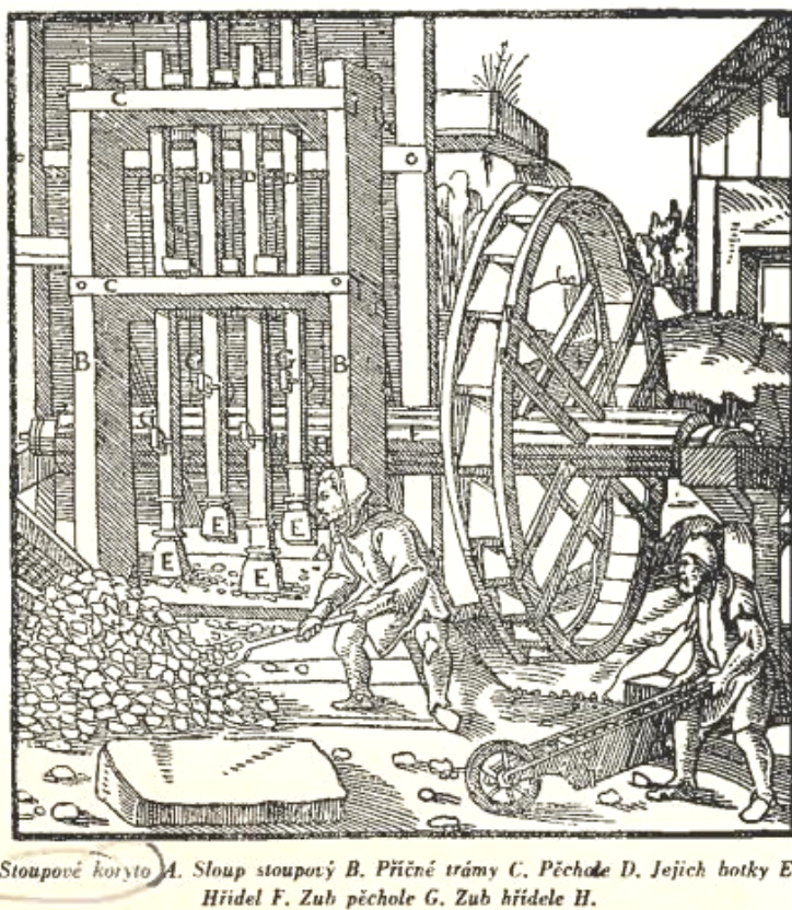
Obr. 28: Stoupa na drcení zlaté rudy poháněná vodním kolem (Agricola, 1556).
