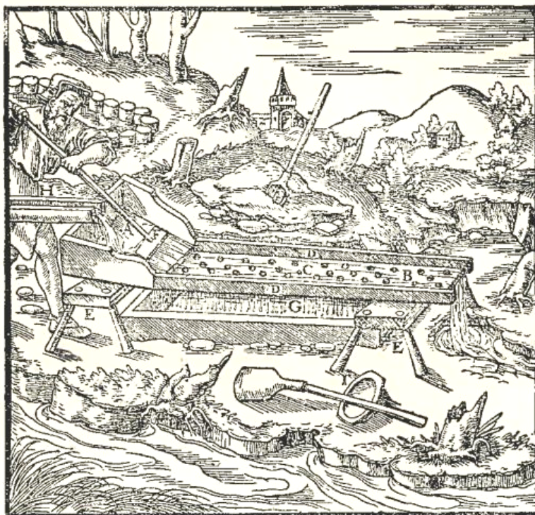
Hlava splavu A. Splav B. Otvory C. Prkna D. Stolička E. Shrnovačka F. Nádržka G. Zlábek H. Necičky I.
