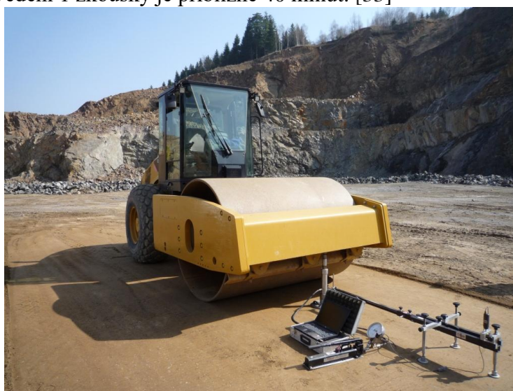
Obr. 132 Průběh statické zatěžovací zkoušky [164]
