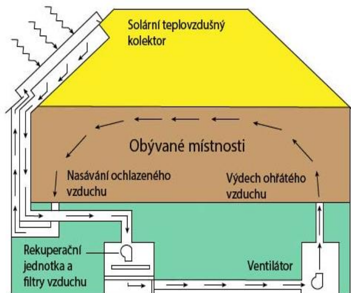
Obr. 5.2 Schéma teplovzdušného solárního vytápění [75]
