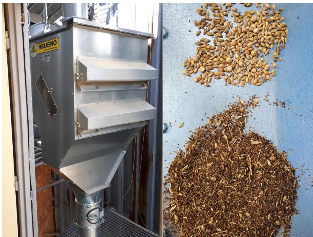
Obrázek 1.6: Aspirační předčistička NDV 40/60 (Foto autor)
