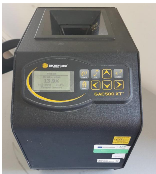
Obrázek 3.2: Příklad přístroje GAC500XT (Foto autor)
