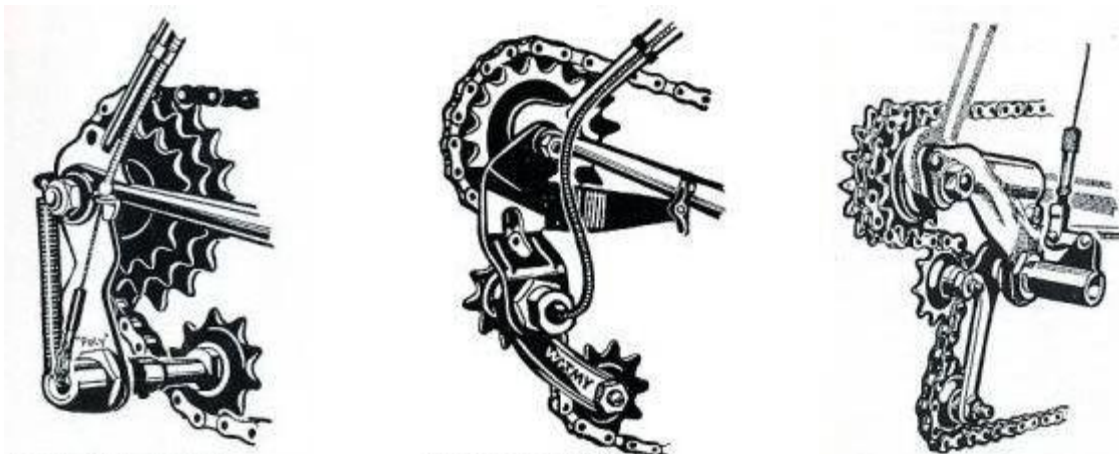
Obr. 8: Příklady některých ranných přehazovaček, které ještě nevyužívaly paralelogramový mechanismus. [14]
