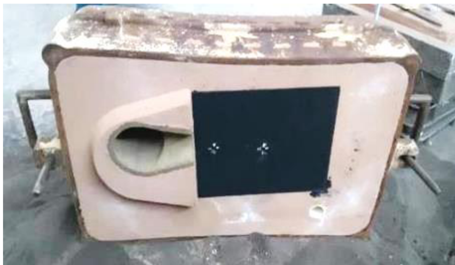
Obr. 14 Fotografie formy s 40 mm vrstvou chromitového písku
