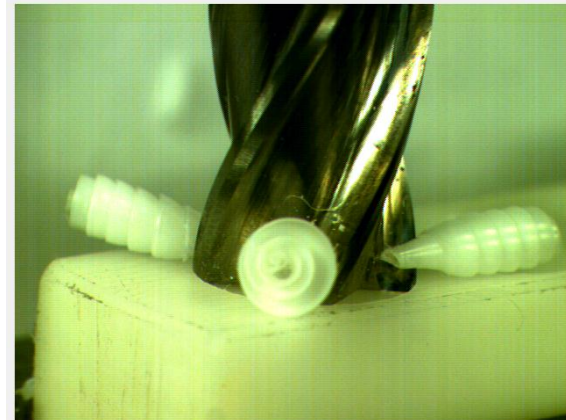
Obr. 6.10 Rozvíjející se průběh utváření třísky při zavrtávání frézy
