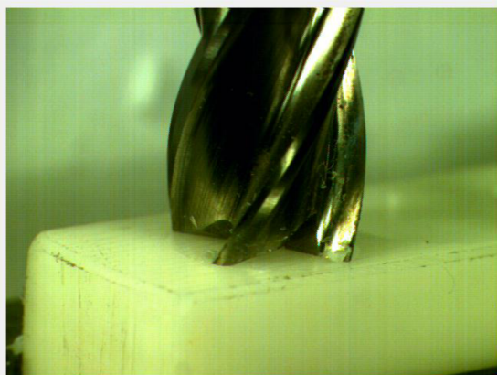
Obr. 6.9 Počátek utváření třísky při zavrtávání frézy
