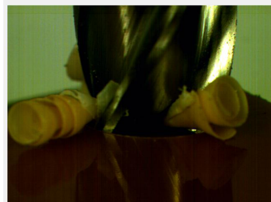
Obr. 6.14 Rozvíjející se průběh utváření třísky při zavrtávání frézy
