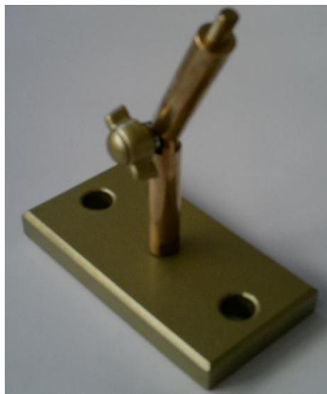
Obr. 6.7 Stativ určený k upnutí kamery
