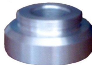
Obr. 6.3 Mezikroužek z duralu o délce 15 mm
