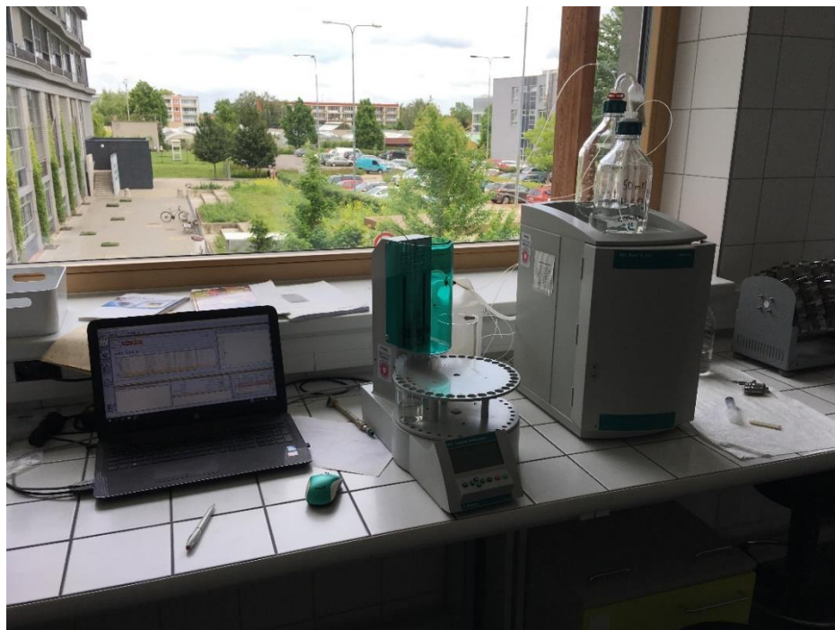
Obr. 11. ČZÚ, Iontový chromatograf Metrohm 883 Basic plus
