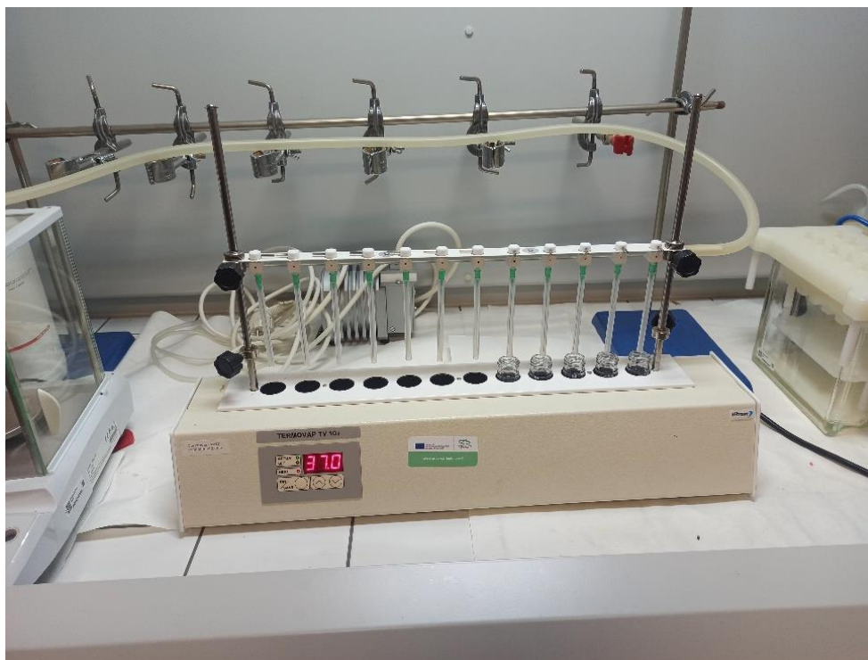
Obr. č. 10 Koncentrátor vzorků (Termovap TV10+, ECOM) (Foto: Tereza Směšná)
