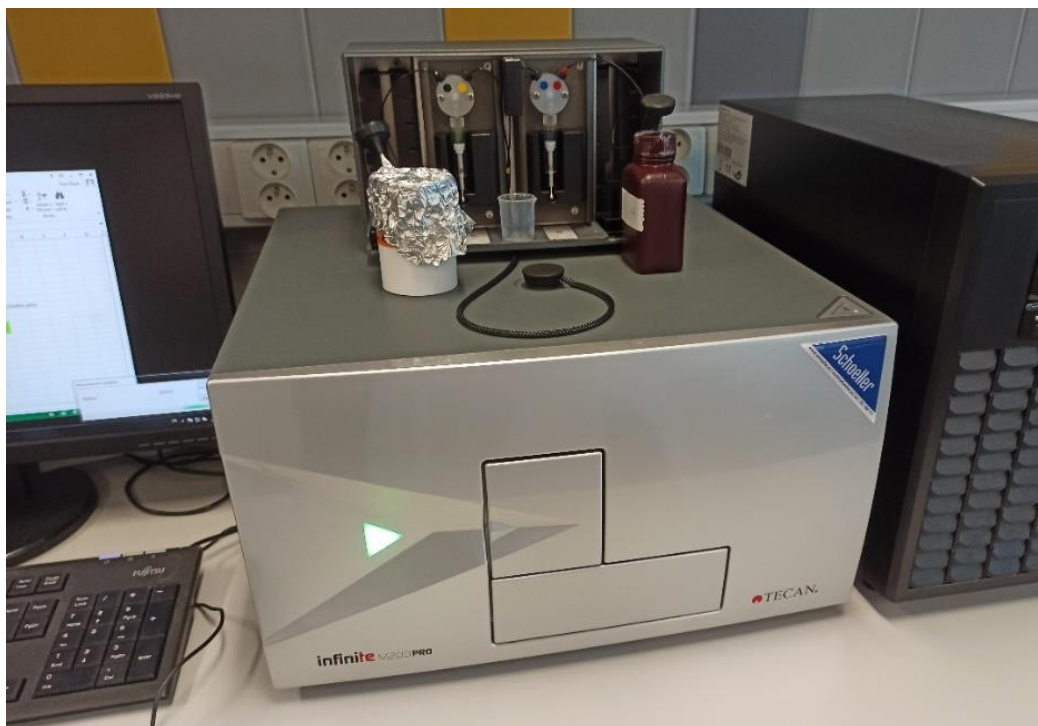
Obr. č. 13 Spektrofotometr s luminiscenčním modulem (M200, Infinite PRO, Tecan, Švýcarsko) (Foto: Tereza Směšná)
