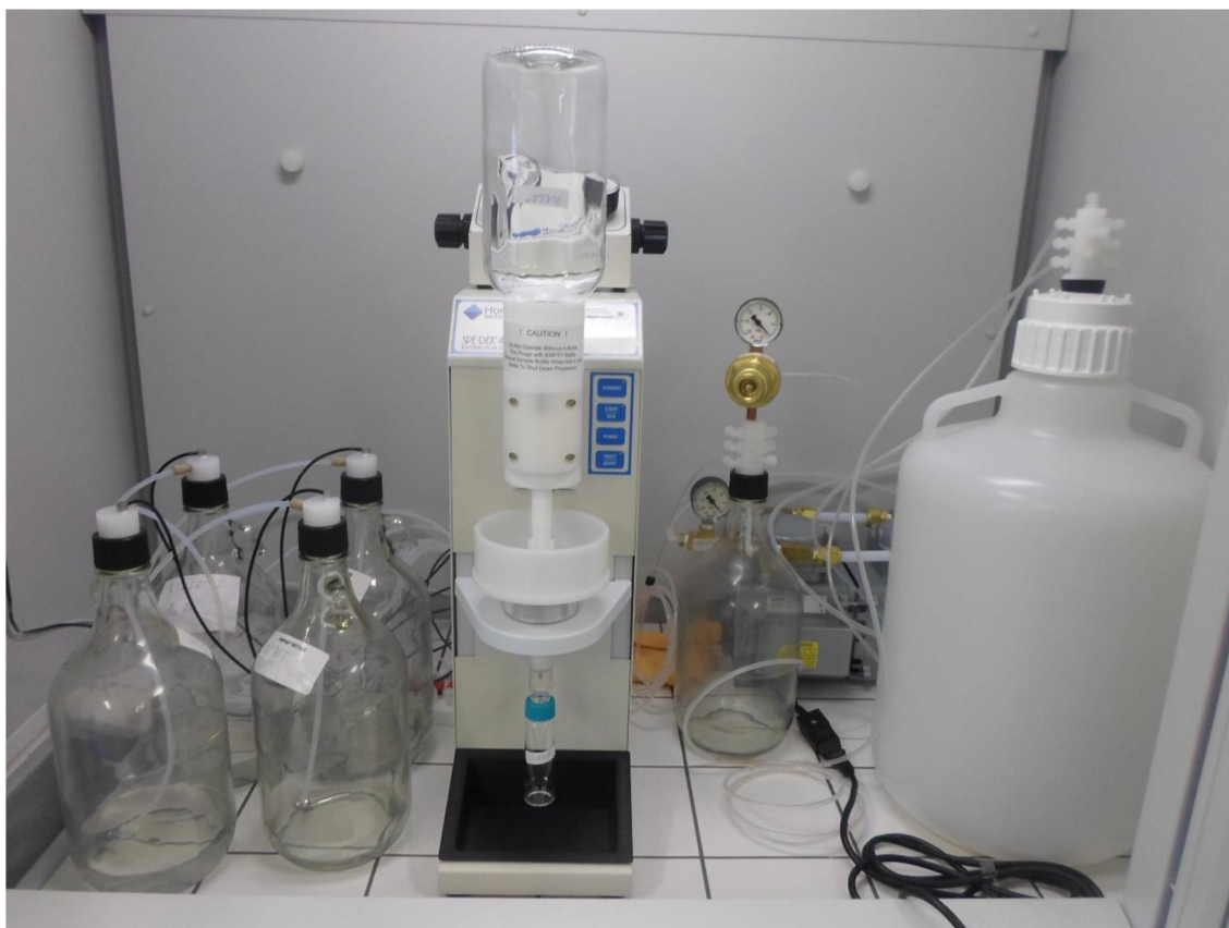
Obr. č. 9 Automatický extraktor SPE-DEX 4790 (Horizon Technology, USA) (foto: Ing. Pavel Šauer, Ph.D.)
