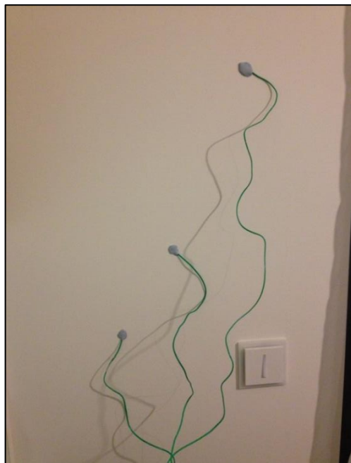
Obr. 20: Kontaktní sonda fixovaná na zeď pomocí termoplastické hmoty.
