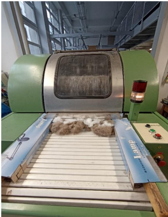
Obrázek 10 První mykání vlákenné vrstvy
