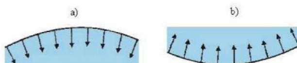
Obrázek 8 Působení zakřiveného povrchu kapaliny na její tvar – kapilární tlak: a) vypuklý (konvexní) povrch kapaliny vzhledem např. ke vzduchu, b) vydutý (konkávní) povrch kapaliny vzhledem např. ke vzduchu [13]
