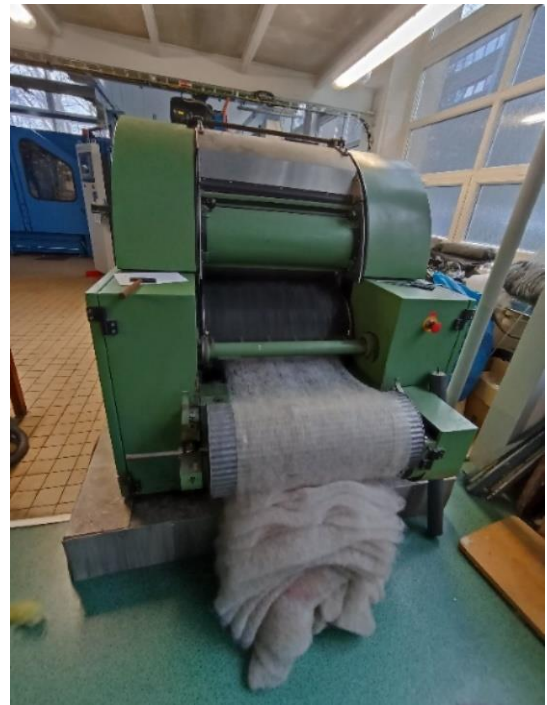
Obrázek 11 Výstup z mykacího stroje
