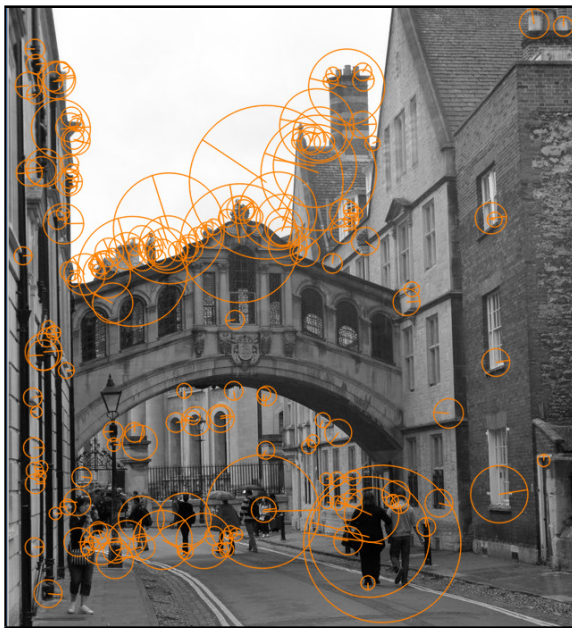
Obrázek 2.3: Ukázka detekce klíčových bodů v obraze (SURF detektor). Střed kružnic znázorňují polohu detekovaného klíčového bodu, poloměr kružnic určuje jeho měřítko.
