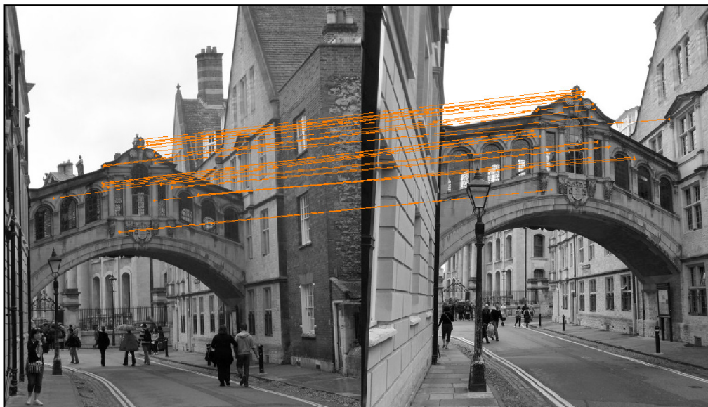
Obrázek 2.5: Ukázka neulezených korespondencí klíčových bodů na dvou fotografiích téhož objektu pořízených z různých pozorovacích úhlů.
