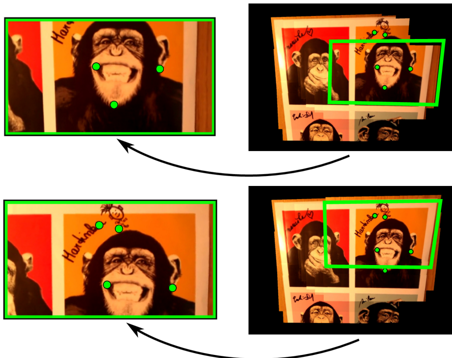
Obrázek 4.4: Zpětná projekce uživatelem definovaných bodů v modelu objektu (vpravo) zpět do obrazu snímku kamery (vlevo).
