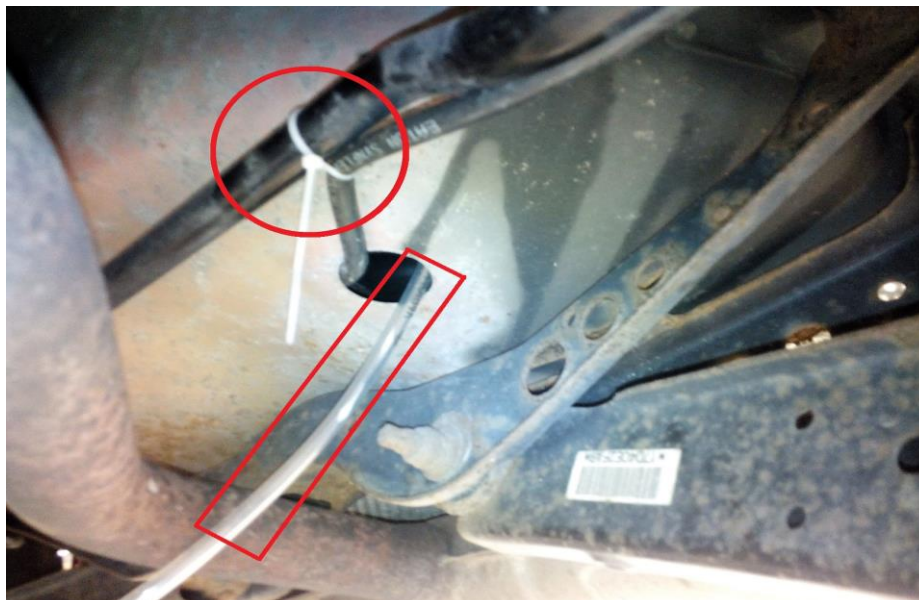
Obrázek 19: Vyvedení a uchycení výfukové a odtokové hadice
