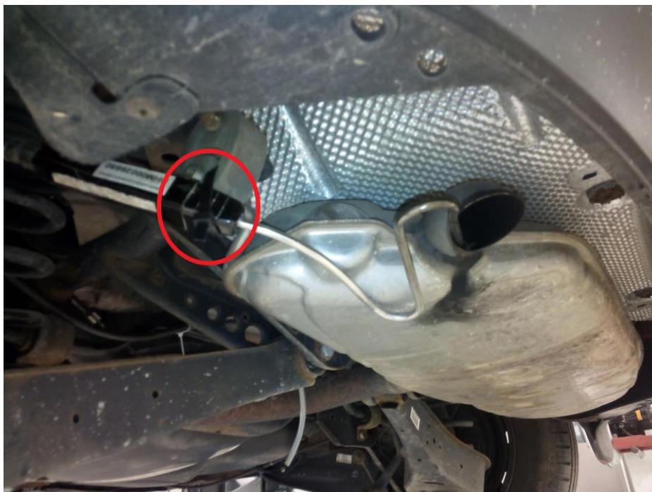
Obrázek 18: Umístění a uchycení výfukové sondy
