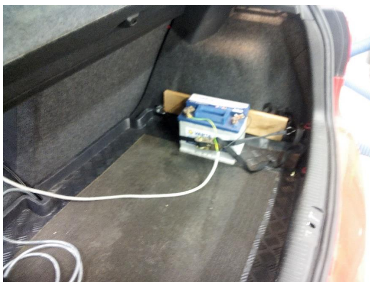
Obrázek 20: Upevnění autobaterie v zavazadlovém prostoru
