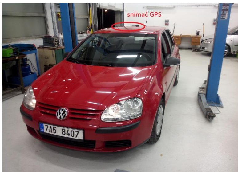
Obrázek 21: Umístění GPS snímače na střeše vozidla
