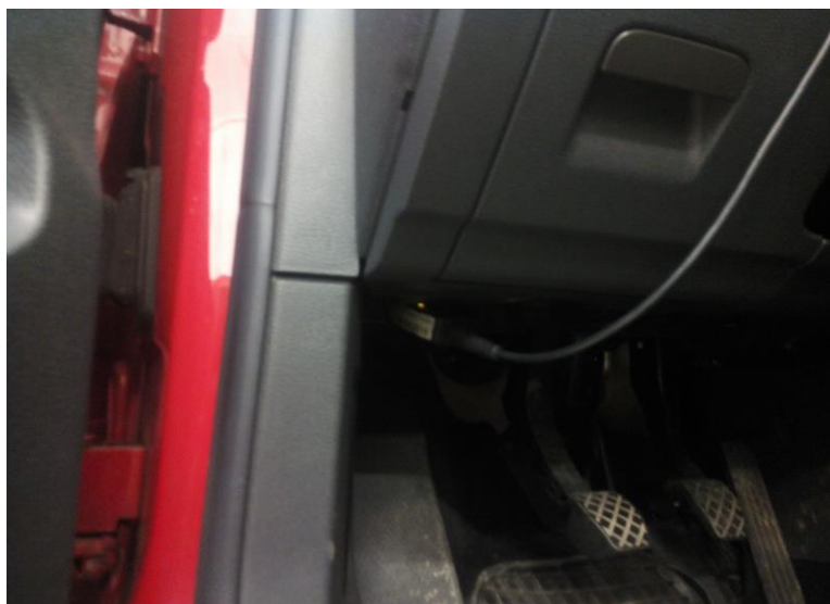
Obrázek 15: Umístění 16pinové diagnostické přípojky
