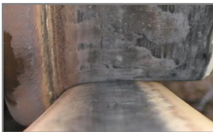
Obr. 2-9 Adhezní opotřebení kola [18]
