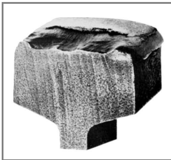
Obr. 2-18 Vytlačení materiálu na čelní straně hlavy kolejnice [22]
