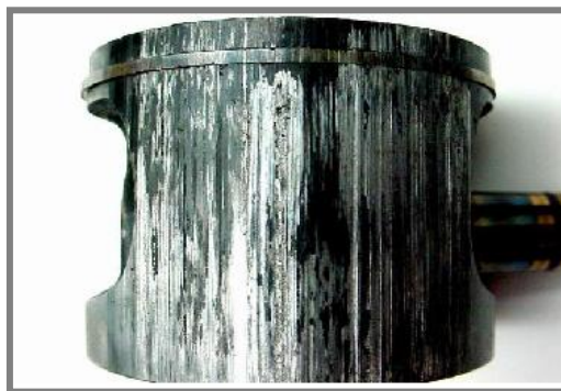
Obr. 2-10 Abrázivní opotřebení pístu [19]
