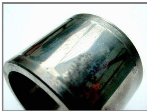
Obr. 2-8 Mírné adhezní opotřebení povrchu pouzdra [13]
