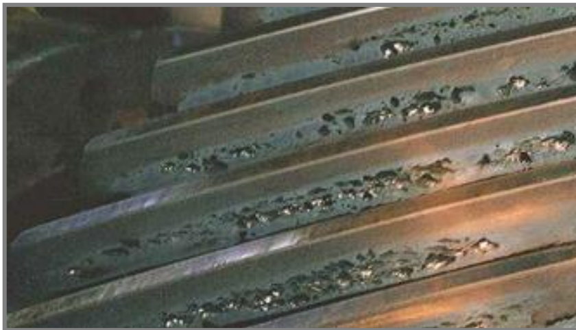
Obr. 2-14 Kontaktní únava (pitting) na boku zubů [21]
