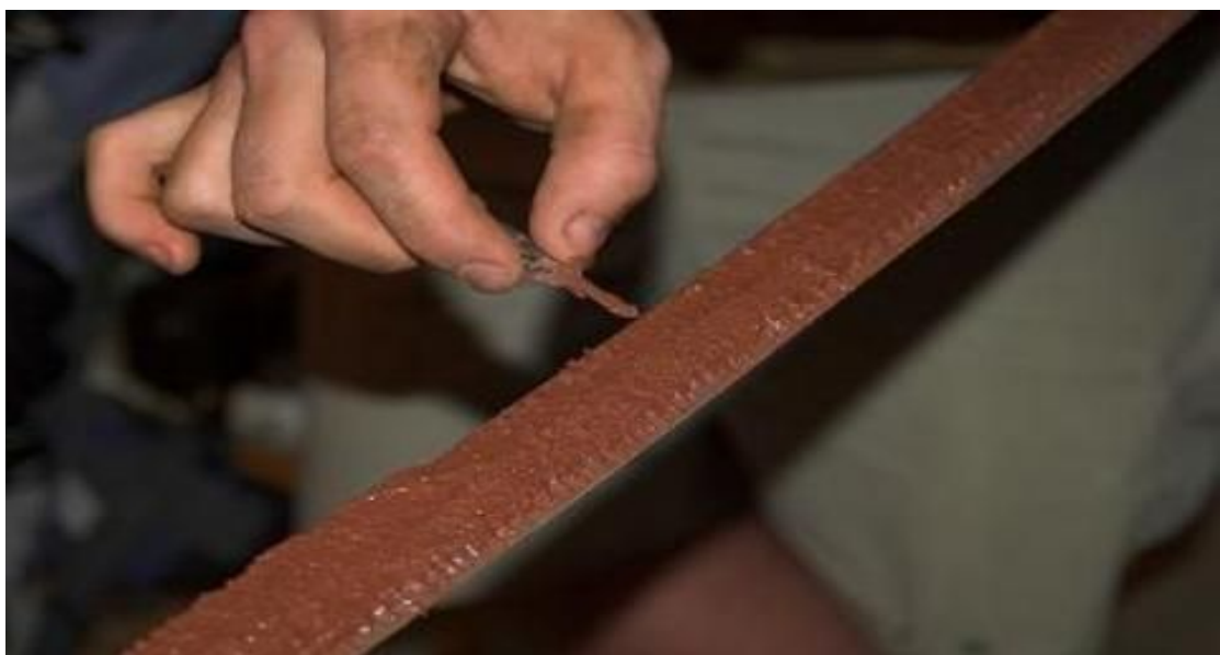
Obr. 17 - Nanášení ochranné vrstvy pro parciální kalení [20]
