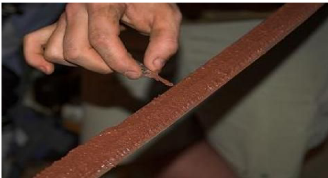
Obr. 17 - Nanášení ochranné vrstvy pro parciální kalení [20]
