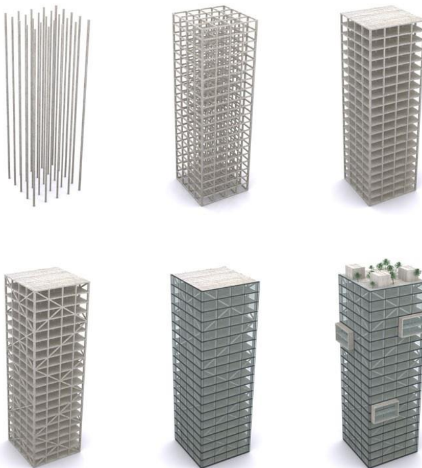
Obrázek 13. 3D návrhy konstrukčního řešení ( www.woodconstruction.com )
