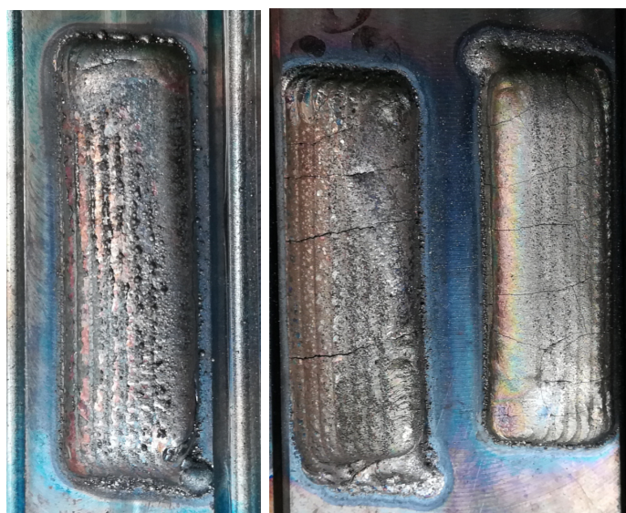
Obrázek 4.2: Návary na hranolu z oceli 12 050 zleva: Metco 42C, Ledurit 60 a Ledurit 68, délka návarů je mezi 6 cm a 7 cm.
