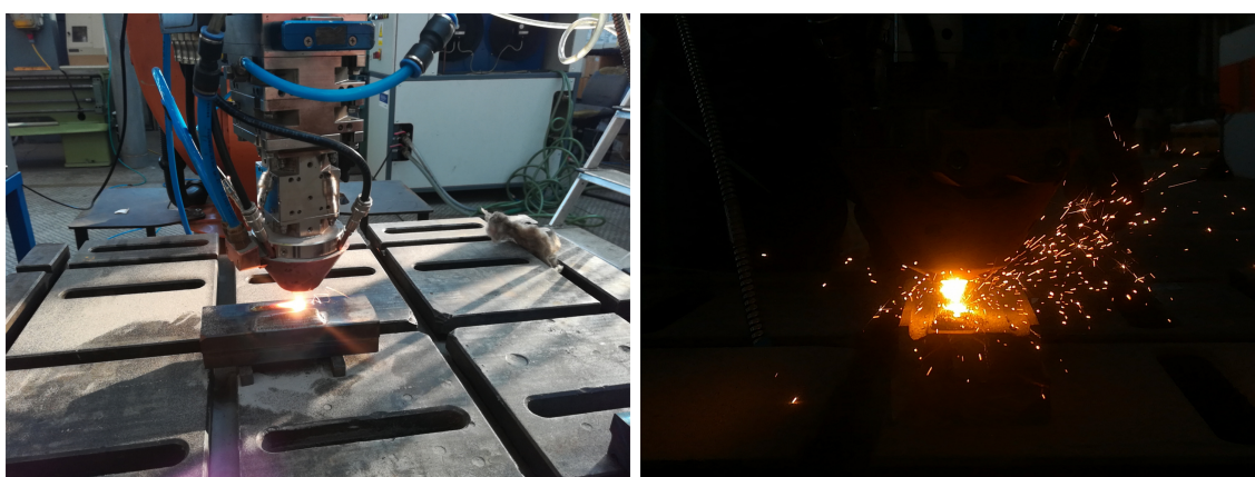
Obrázek 4.1: Laserová hlava při práci - prášek je sypán černými trubicemi rovnoměrně ze čtyř stran, na pozadí se nachází diodový laser Laserline (vlevo). Při navařování dochází k vysokým ztrátám materiálu a jeho degradaci (vpravo).
