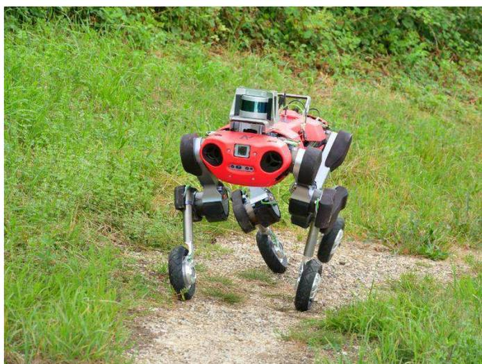
Obr. 5: Hybridní robot ANYmal ETH Zurich [4]
