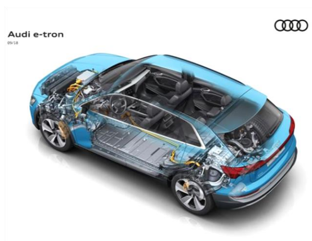
Obrázek č. 7 - Audi e-tron, podlahu tvoří akumulátory, elektromotor je vpředu i vzadu.
