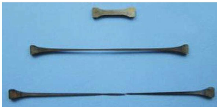
Obr. 2.8 Využití TWIP efektu u ocelí (deformace > 1000 %) [2]
