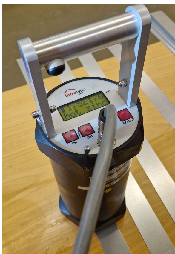
Obr. 3.11 Přístroj na měření nanesené vrstvy oleje přístroj NG1 vyráběný společností InfraLytic GmbH
