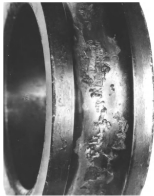
Obr. 2.30 Příklad únavového opotřebení u kuličkového ložiska [9]
