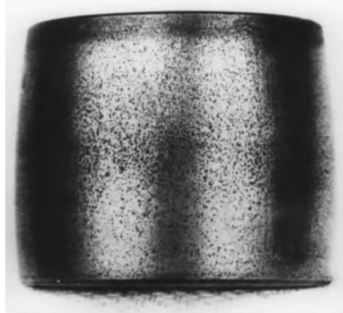
Obr. 2.32 Příklad korozivního opotřebení [9]
