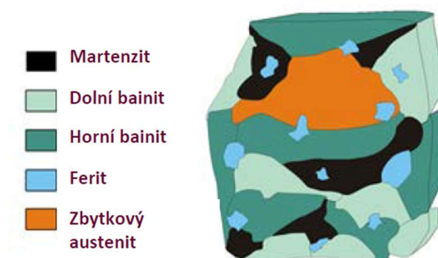
Obr. 2.11 Schématické znázornění mikrostruktury CP ocelí [2]
