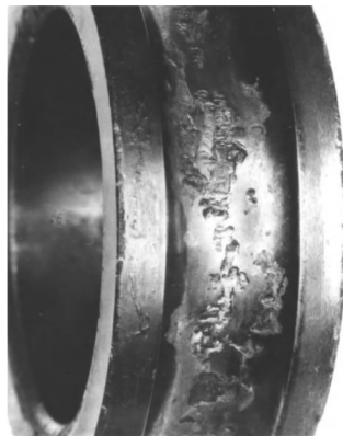
Obr. 2.30 Příklad únavového opotřebení u kuličkového ložiska [9]
