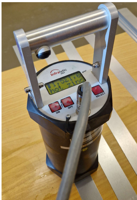
Obr. 3.11 Přístroj na měření nanosené vrstvy oleje přístroj NG1 vyráběný společností InfraLytic GmbH
