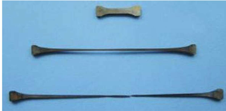
Obr. 2.8 Využití TWIP efektu u ocelí (deformace > 1000 %) [2]
