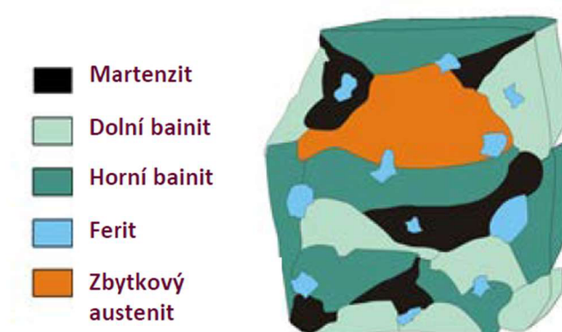
Obr. 2.11 Schématické znázornění mikrostruktury CP ocelí [2]
