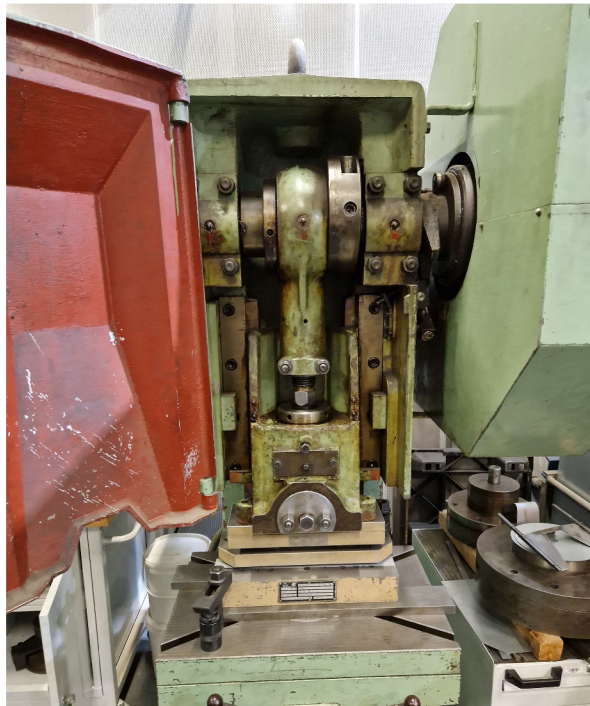
Obr. 3.5 Výstředníkový lis LENP 40 s upnutým přípravkem pro vystřížení zkušebních tělísek
