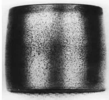
Obr. 2.32 Příklad korozivního opotřebení [9]
