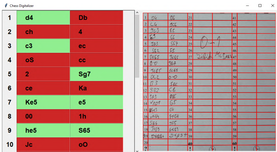
Obr. 6.1: Ukážka okna na opravu chýb vygenerovaných ťahov. Užívateľ môže opraviť zle vygenerované ťahy a skontrolovať celú transkripciu. Užívateľ takisto vidí náhľad partiáru a výsledok segmentácie buniek.
