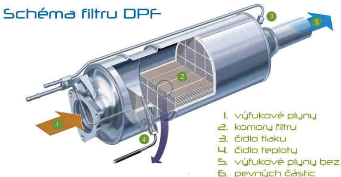
Obrázek 22: Filtr pevných částic [11]
