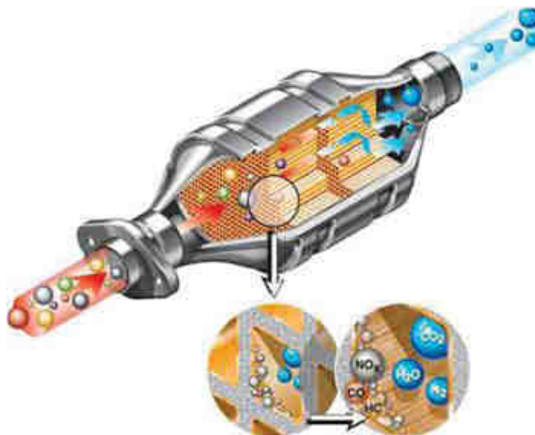
Obrázek 21: Řez oxidačním katalyzátorem [23]
