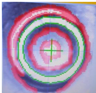
Obr. 33: Detekované hrany s odstraněním okolních šumů
