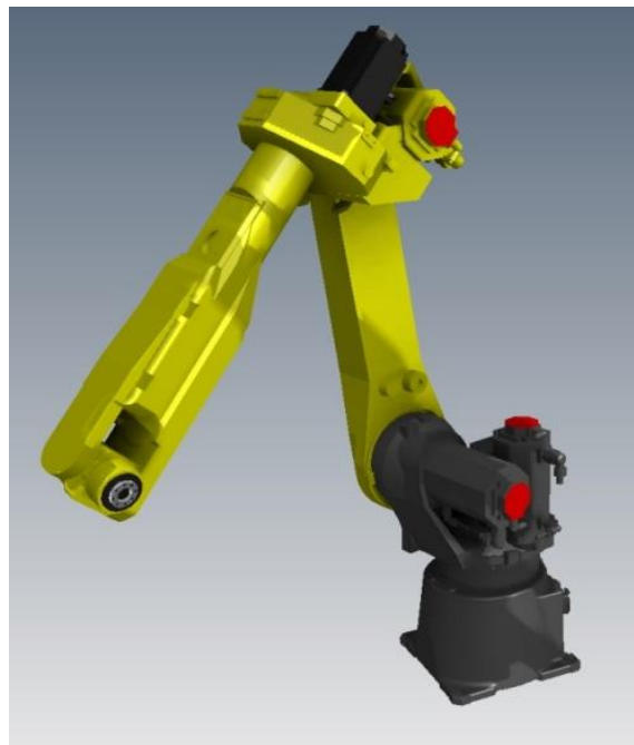
Obr. 16: Průmyslový robot FANUC M-20iA/35M
