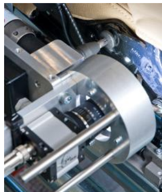
Obr. 23: Uložení kamery v efektoru Faude [29]
