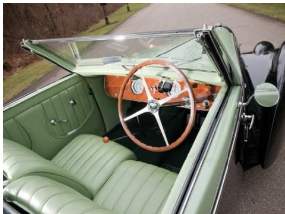
Obr. 3: Polohovatelná sedadla vozu Bugatti Type 57 1938 [5]
