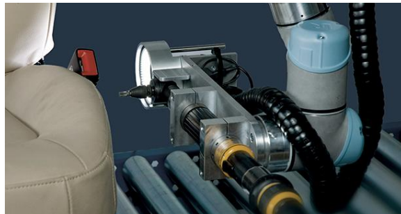
Obr. 22: Koncový efektor společnosti Faude Automatisierungstechnik [29]
