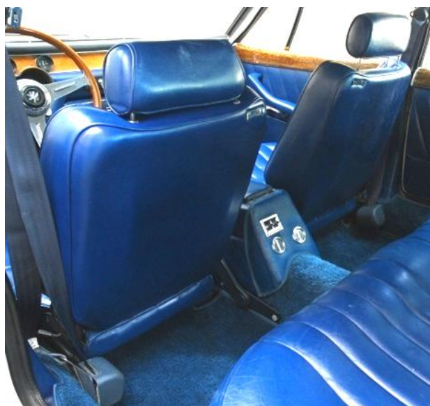
Obr. 5: Uchycení spony pásu u vozu Iso Fidia 1970 [5]
