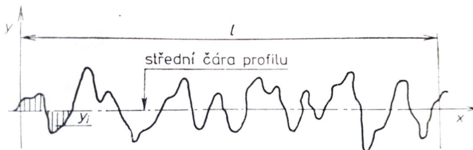
Obr. 2 Schéma střední čáry profilu m
