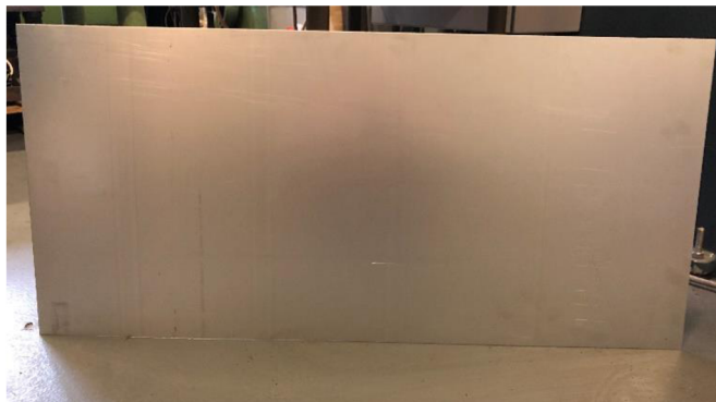
Obr. 19 Tabule HDG plechu před stříhem
