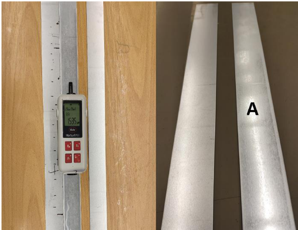
Obr. 26 Měření drsnosti povrchu a vzhled vzorku po zkoušce (A)
