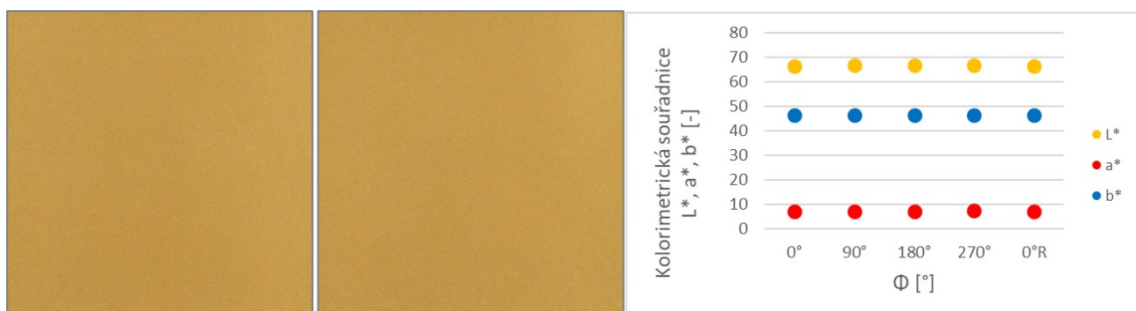
Obrázek 48. Vzorek s jemným homogenním povrchem 1320. Vizuální a numerický průběh změn při otáčení vzorku v úhlu \Phi .
