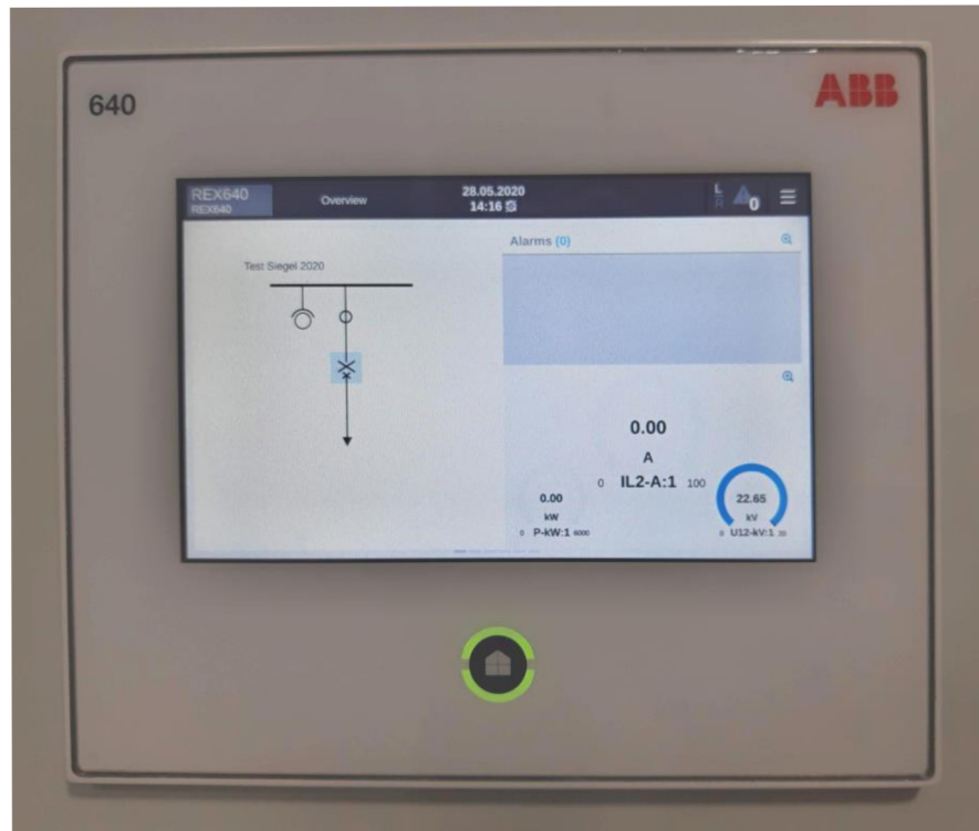
Obr. 6-4 Úspěšně nahraná konfigurace do jednotky – svítí zelená LED
