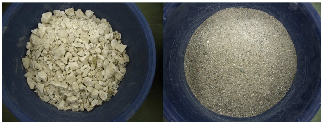
Obr. 15 - Suroviny pro přípravu horké malty: kusové pálené vápno a omítkový písek
