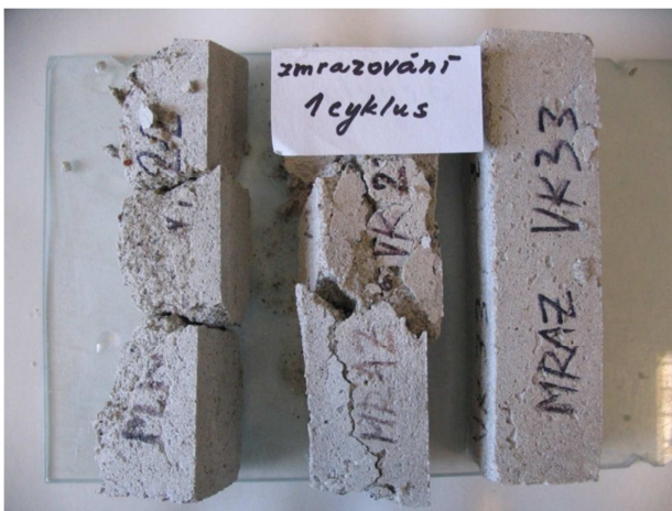
Obr. 62 - Zkušební vzorky neodležené malty připravené z vápenné kaše a omítkového písku po 1 zmrazovacím cyklu
