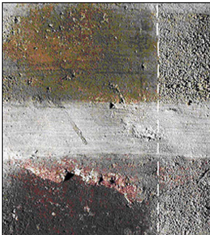
Obr. 9 - Stav fresky před aplikací (vpravo od čárkované čáry) a po aplikaci disperze nanočástic \text{Ca}(\text{OH})_2 [19]
