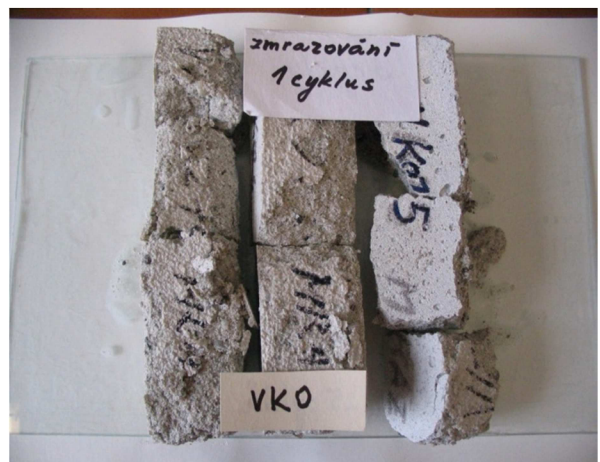
Obr. 63 - Zkušební vzorky odležené malty připravené z vápenné kaše a omítkového písku po 1 zmrazovacím cyklu
