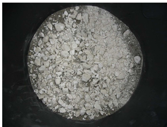
Obr. 16 - Při přípravě horké malty se vrstvy písku střídají s vrstvami kusového vápna
