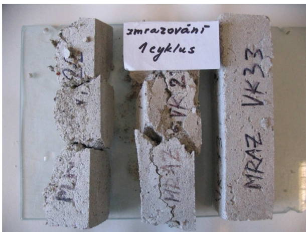
Obr. 62 - Zkušební vzorky neodležené malty připravené z vápenné kaše a omítkového písku po 1 zmrazovacím cyklu
