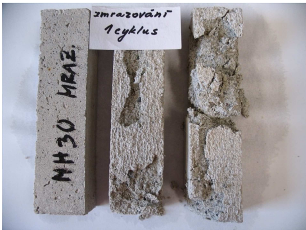
Obr. 60 - Zkušební vzorky neodležené malty připravené z aktivovaného vápenného hydrátu a omítkového písku po 1 zmrazovacím cyklu
